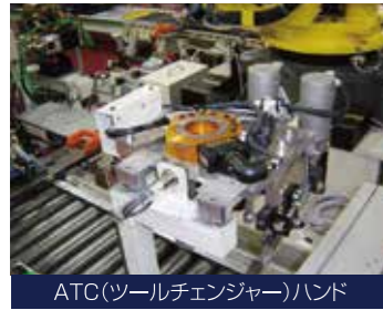
ハンドリングロボット ATCを利用してハンド交換を自動で行うハンドリングロボット
